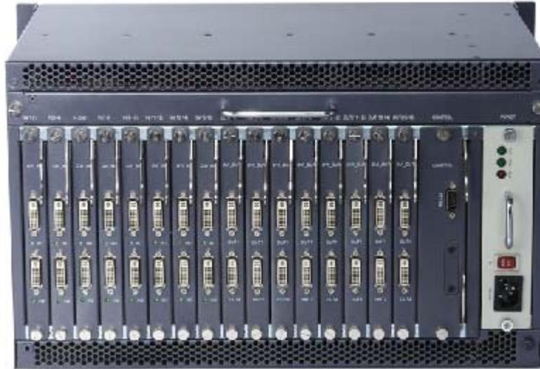
**HN-MIX 数字矩阵切换器**是一款专门针对不同格式输入信号采集切、切换、分配集一体的高性能数字矩阵开关设备。
